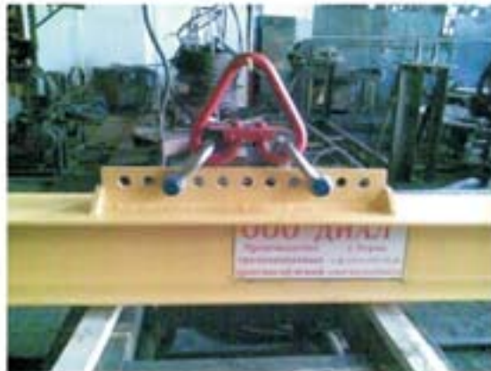
Траверса с переставными такелажными точками
