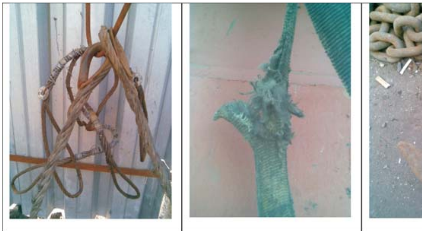
Стропы, которые необходимо срочно изъять из эксплуатации
